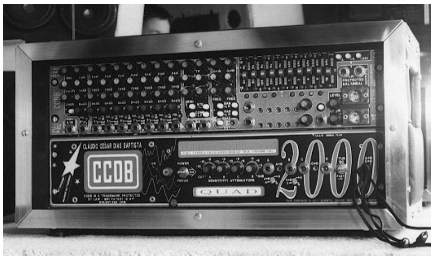
Foto 27 - Amplificador Turbo-Compressor QUAD 2000 CCDB, que substituiu um P.A. estéreo completo, com divisores eletrônicos de três vias, equalizadores paramétricos e gráficos, limitadores, misturador com controles panorâmicos e muito mais recursos. O prospecto e o manual deste aparelho levaram seis meses para serem escritos e valem como um curso completo de sonorização
