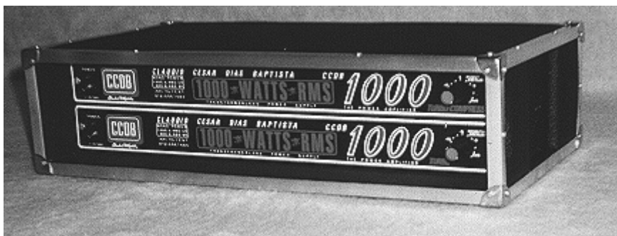
Foto 21 - Rack com dois amplificadores CCDB 1000, sem transformador de força
