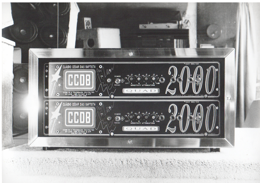
Foto 23 - Rack com dois amplificadores CCDB Quad 2000. Cada amplificador contém quatro seções de potência de 500W RMS. Neste rack, o Rack Octa, há sessenta e quatro transistores de potência de 200W cada, duas ventoinhas, conectores pesados para caixas acústicas; num espaço onde, anos antes, CCDB montava amplificadores com um oitavo dos transistores e da potência
