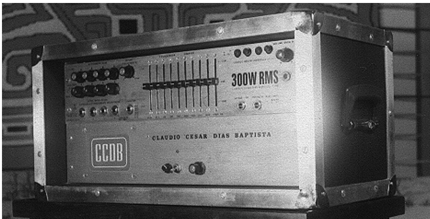
Foto 24 - Antigo amplificador CCDB de 300W RMS, com pré, para instrumentos musicais e vozes, donde saíram os lendários amplificadores Turbo-Compressor CCDB, capazes de amplificarem, sozinhos, toda uma banda
