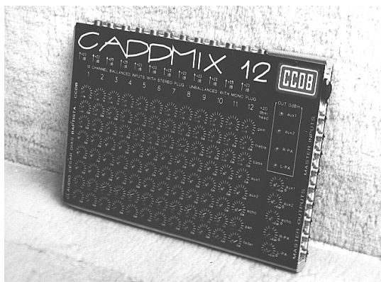
Foto 35 - CCDB CADD MIX 12. Menor mesa de doze canais do mundo, projetada por CCDB em CADD, com todos os recursos necessários para sonorização e gravação. Pesa apenas 720 gramas, cabe na palma da mão, e sua fonte de alimentação externa fica no próprio cordão de conexão à rede elétrica. Capa da revista Música e Tecnologia Junho/Julho 1991
